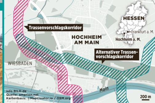
Für das Verlegen der Erdkabel muss auf einer Breite von bis zu 70 Metern aufgedigelt werden, um sie zu verlegen. Auf 24 Metern Breite dürfen auf den Kabeln keine Weinstöcke mehr gepflanzt werden
