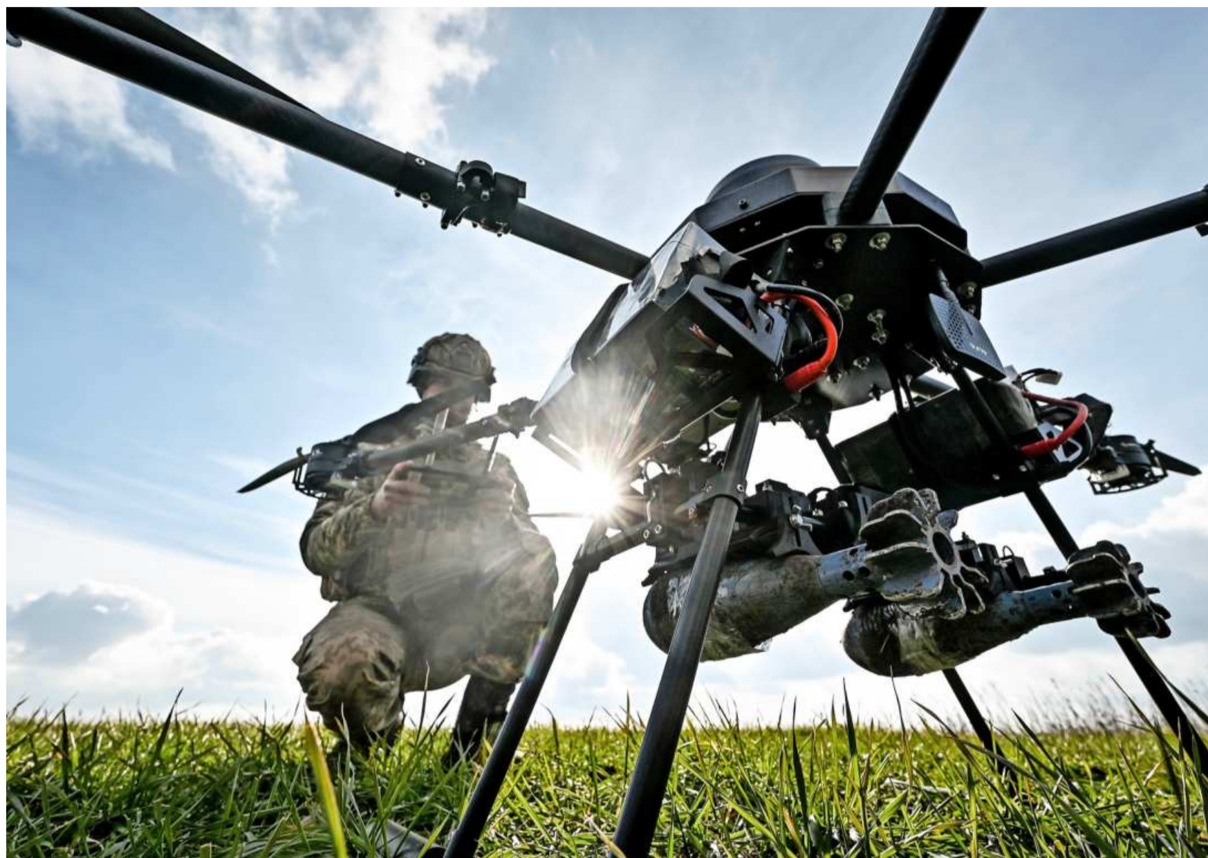
Saporischschja, Ukraine, im Februar 2024: Ein Soldat startet eine Drohne, die eine Nutzlast von bis zu 15 Kilogramm hat und mit einer Wärmebildkamera ausgestattet ist. Foto dpa
