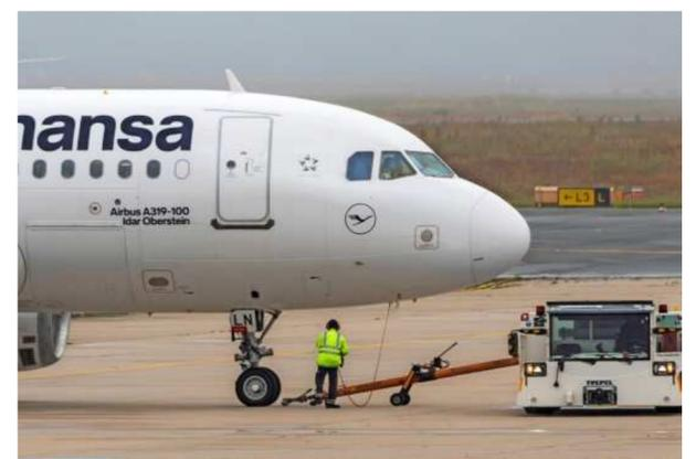
Kurz vorm Andocken: Eine Stange verbindet Schlepper und Flugzeug.
