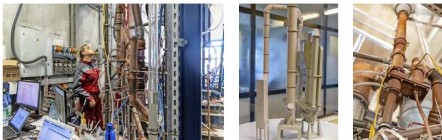
Probelauf: Mitarbeiter simulieren am Kaltmodell (links und rechts) verschiedene Prozesse, die in der Anlage ablaufen, von der ein Modell aus dem 3-D-Drucker (Mitte) im Institut steht.
