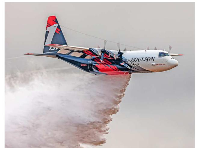
Die buschpistentaugliche C-130 Hercules wird mithilfe eines portablen Löschesystems innerhalb von 30 Minuten zum Feuerlöschflugzeug.
