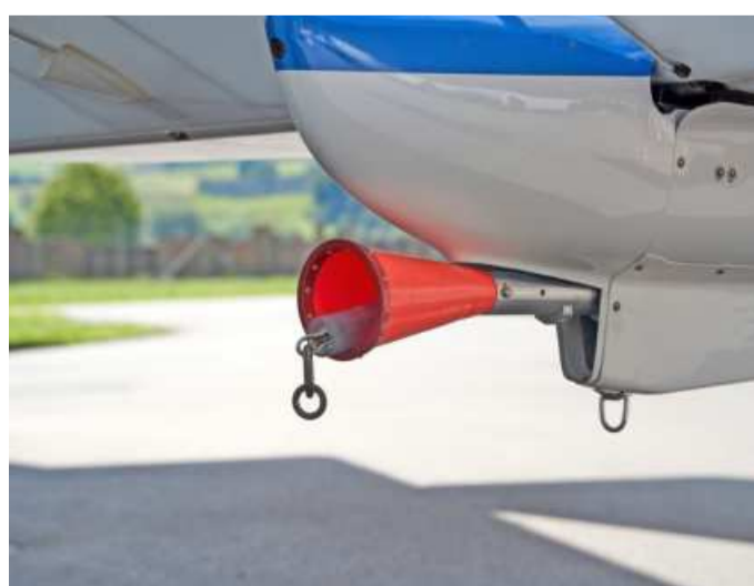
Verstaut: Das Schleppseil wird nach dem Ausklinken des Segelflugzeugs eingezogen und per Elektromotor aufgerollt.
