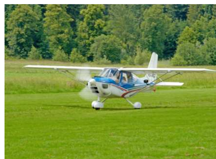
Schnell wieder unten: Die Lightwing kann mit bis zu 17 Metern in der Sekunde zur Erde sinken, das spart Treibstoff und Zeit.
