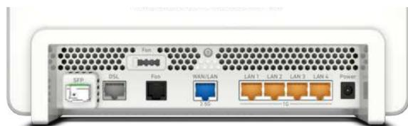
In tiefer Verbundenheit: Die Fritzbox zeigt auf ihrer Rückseite (von links nach rechts) den Anschluss für Glasfaser, DSL, Telefonie, einen schnellen LAN-Anschluss sowie vier 1-Gigabit-LAN-Anschlüsse.
