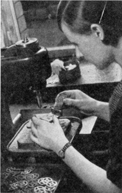
Bohren mittels Bohrlehre
