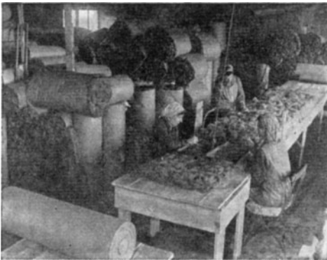
In Form von Matten wird die Basaltwolle für Isolierzwecke geliefert
